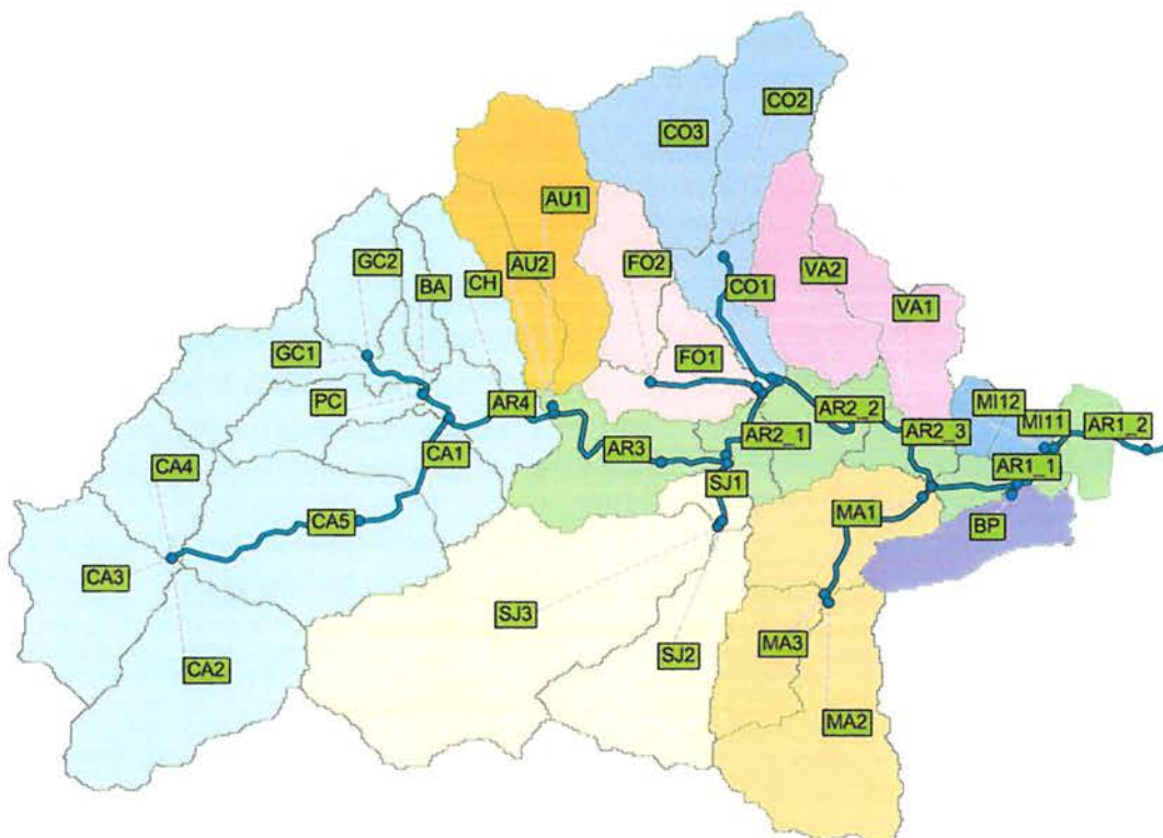
Figure 31 : Structure du modèle hydrologique du bassin versant du Riou de l'Argentière
